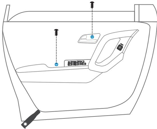
Com uma espátula fina, retire a tampa dos parafusos. Em seguida retire os parafusos para retirar o forro da porta e iniciar a instalação.
